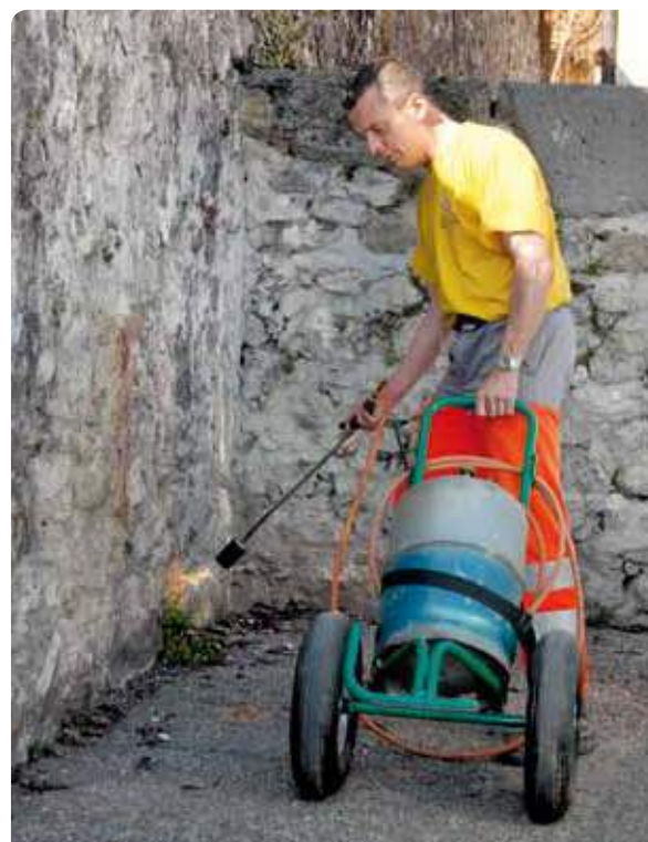
Désherbeur thermique à flamme directe utilisé en pied de mur. Le Touvet, 3 000 hab.
