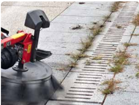
Brosse mécanique sur porte-outil à conducteur marchant employée pour désherber les joints. Grenoble, 160 000 hab.
